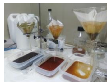
Cromatograma y fotografía de distintos extractos acuosos de biomasa de espirulina obtenidos con diferentes procesos enzimáticos.
